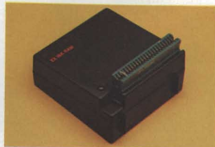
Nella foto l'espansione RAM da 16 Kbyte che consente un notevole aumento delle capacità dello ZX81.
